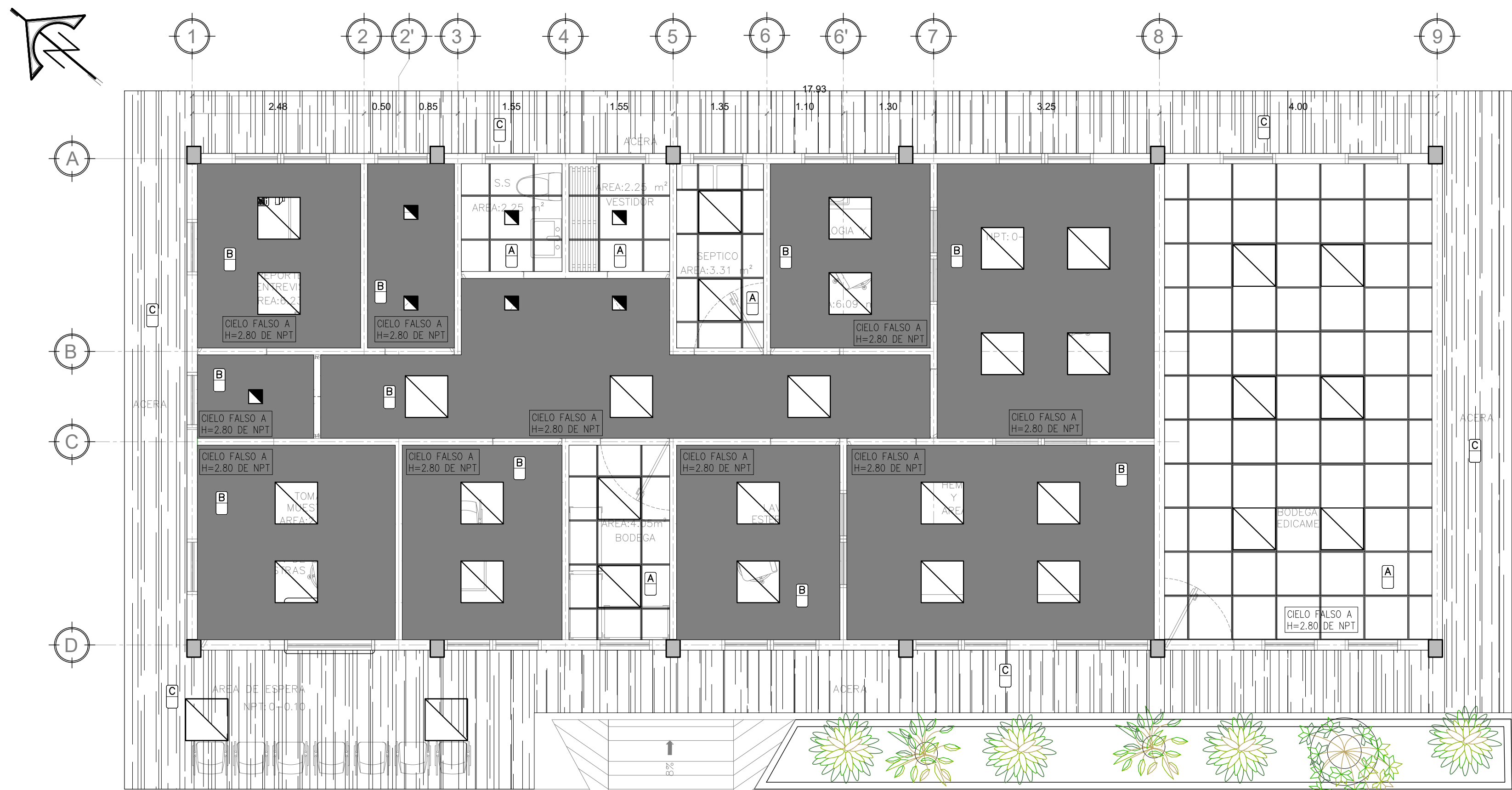
PLANTA DE CIELO REFLEJADO – MÓDULO LABORATORIO CLÍNICO UNIDAD DE SALUD INTERMEDIA EL TRIUNFO (PROYECTADO) Escala 1:50 NPT: 0-0.20
