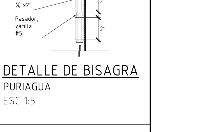
DETALLE DE BISAGRA PURIAGUA ESCALA 1:5
