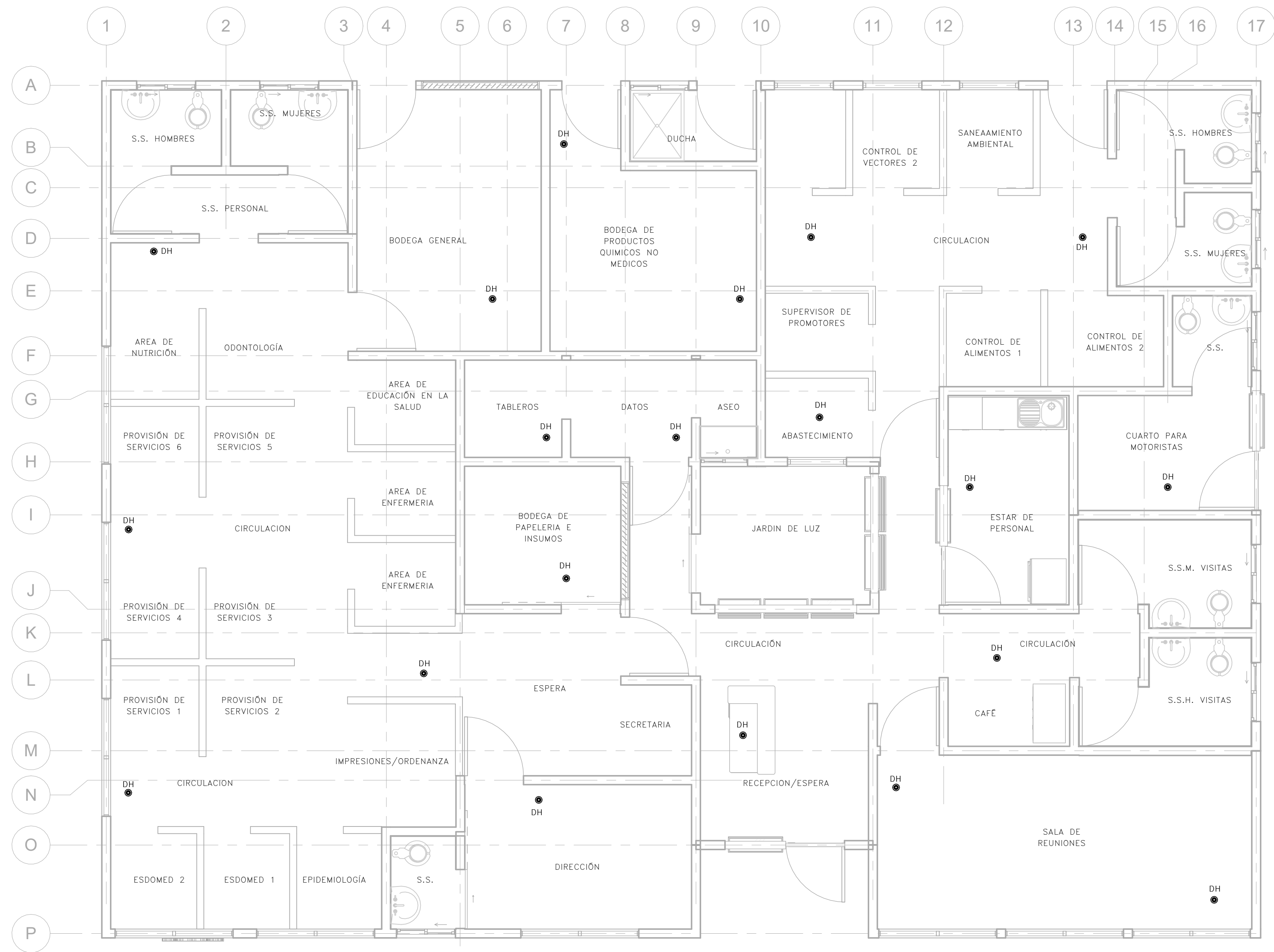
1 PLANO DE INSTALACIONES DE SEÑALES DÉBILES - SISTEMA DE DETECCIÓN DE INCENDIO DEL MÓDULO SIBASI - CENTRO
