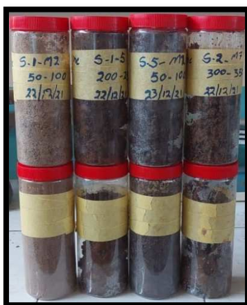
Ilustración 3. Recolección y Manejo de muestras de Ensayo SPT.
