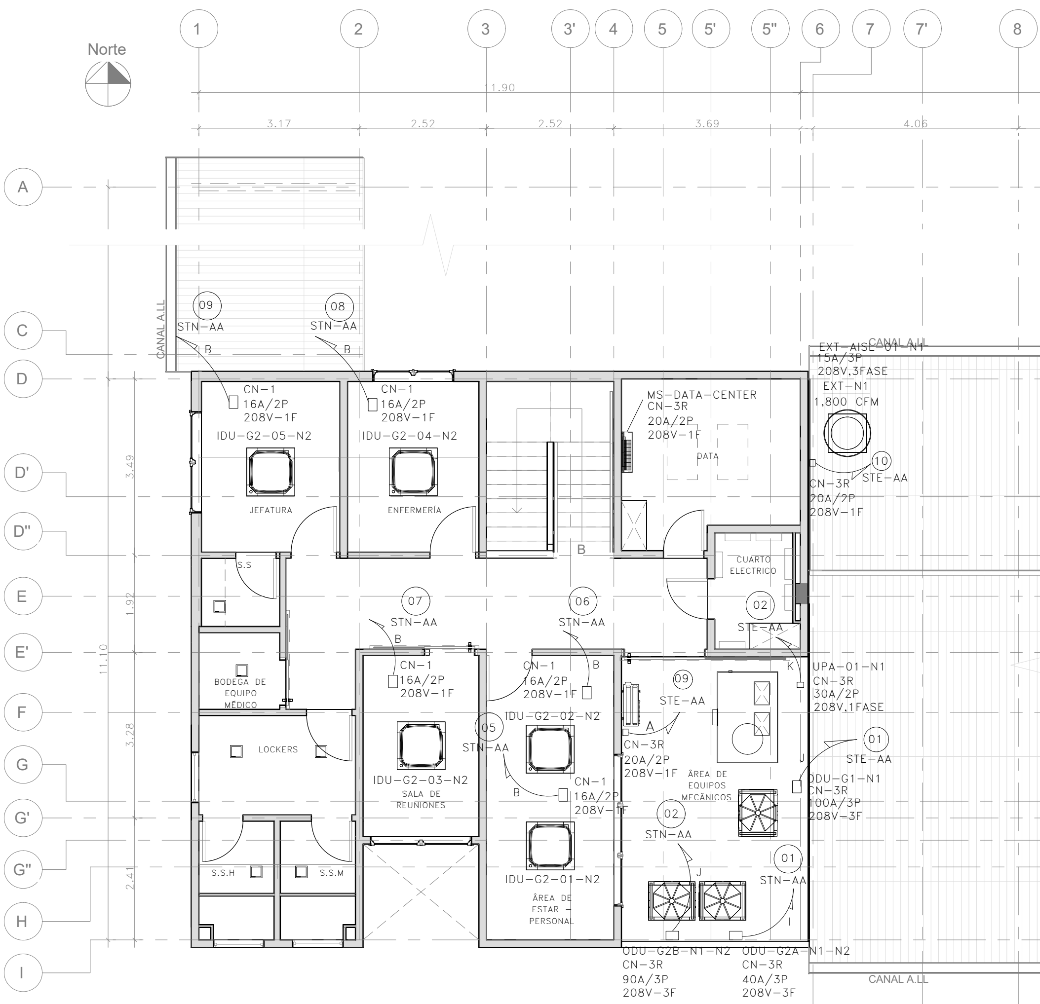
1 PLANO DE INST. ELÉCT. - EQUIPOS MECANICOS - NIVEL 2 1 : 75
