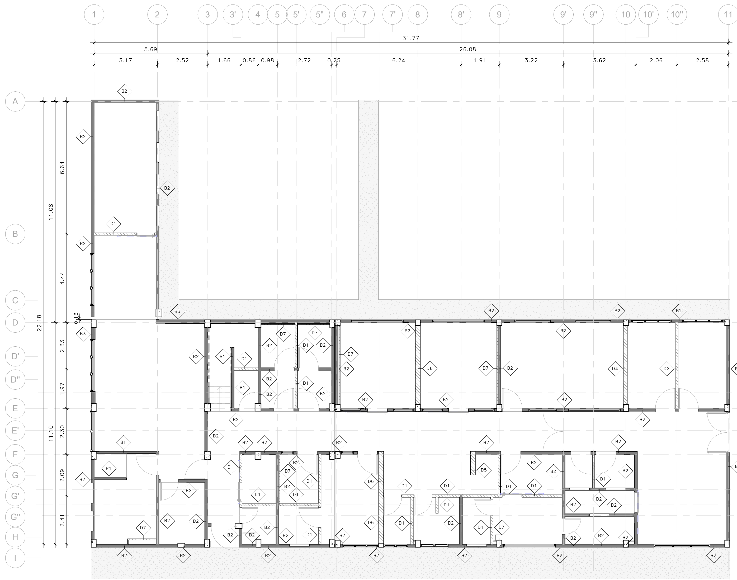
1 PLANTA TIPOS DE MURO NIVEL 1 SERVICIO DE NEONATOLOGÍA 1 : 100
