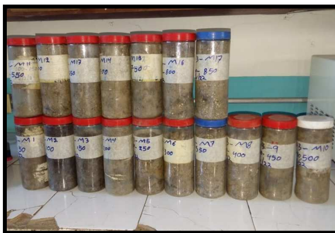
Ilustración 3. Recolección y Manejo de muestras de Ensayo SPT.
