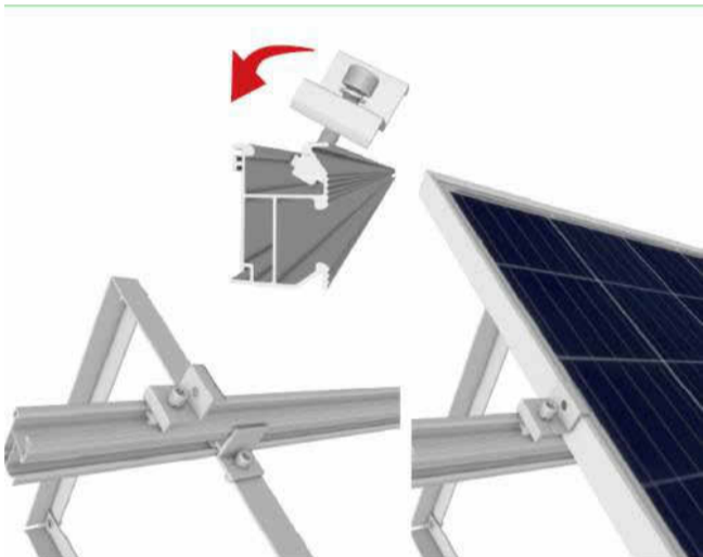
DETALLE TÍPICO DE ABRAZADERA FINAL, ABRAZADERA INTERMEDIA.
