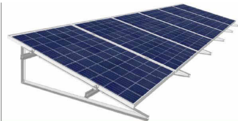
DETALLE TÍPICO PANEL FV INSTALADO EN ESTRUCTURA DE MONTAJE TRIANGULAR VERTICAL PARA 9 PANELES.
