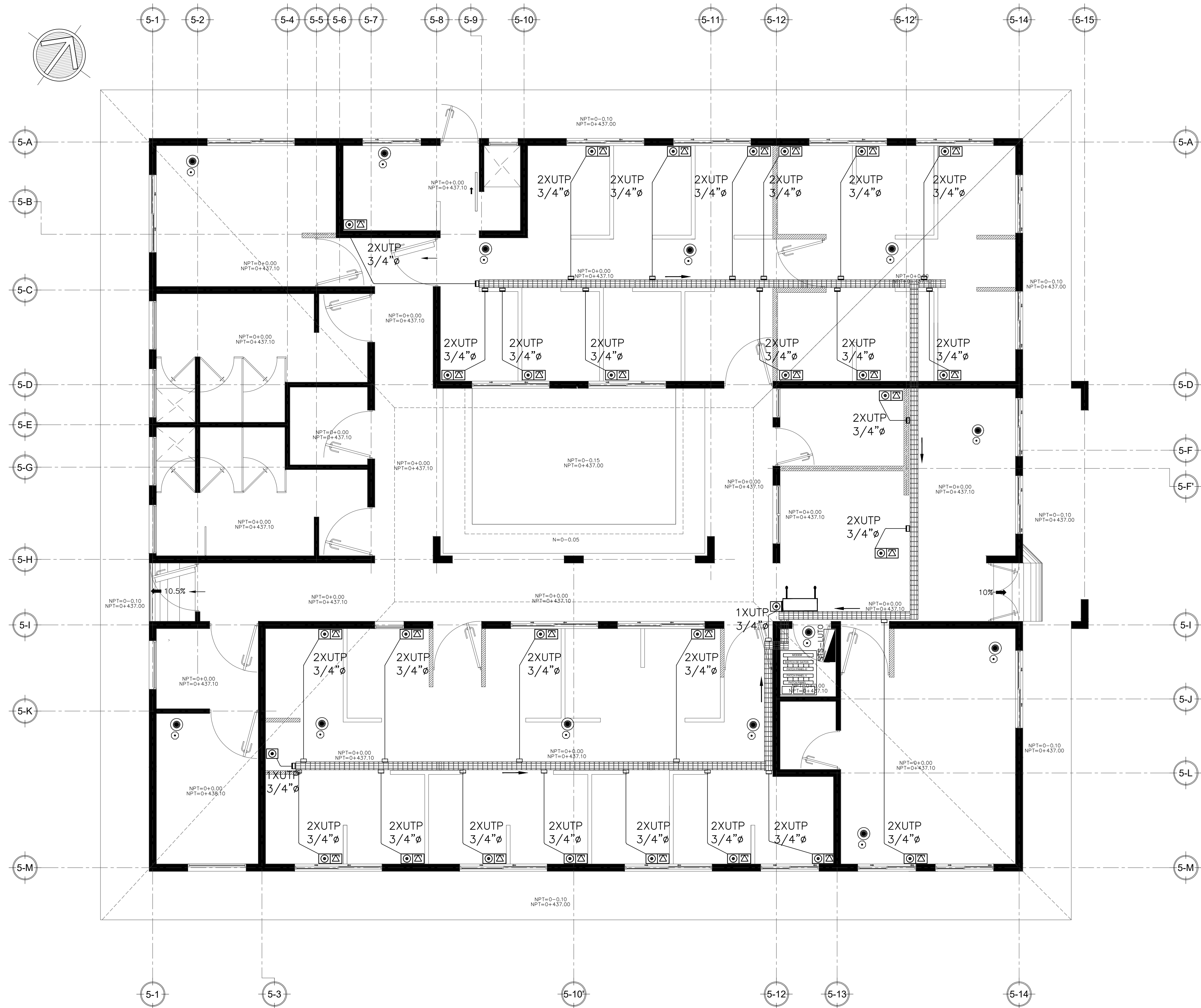
PLANTA DE INSTALACIONES ESPECIALES INCENDIO, VOZ Y DATOS MÓDULOS DE OFICINAS Esc 1:50
