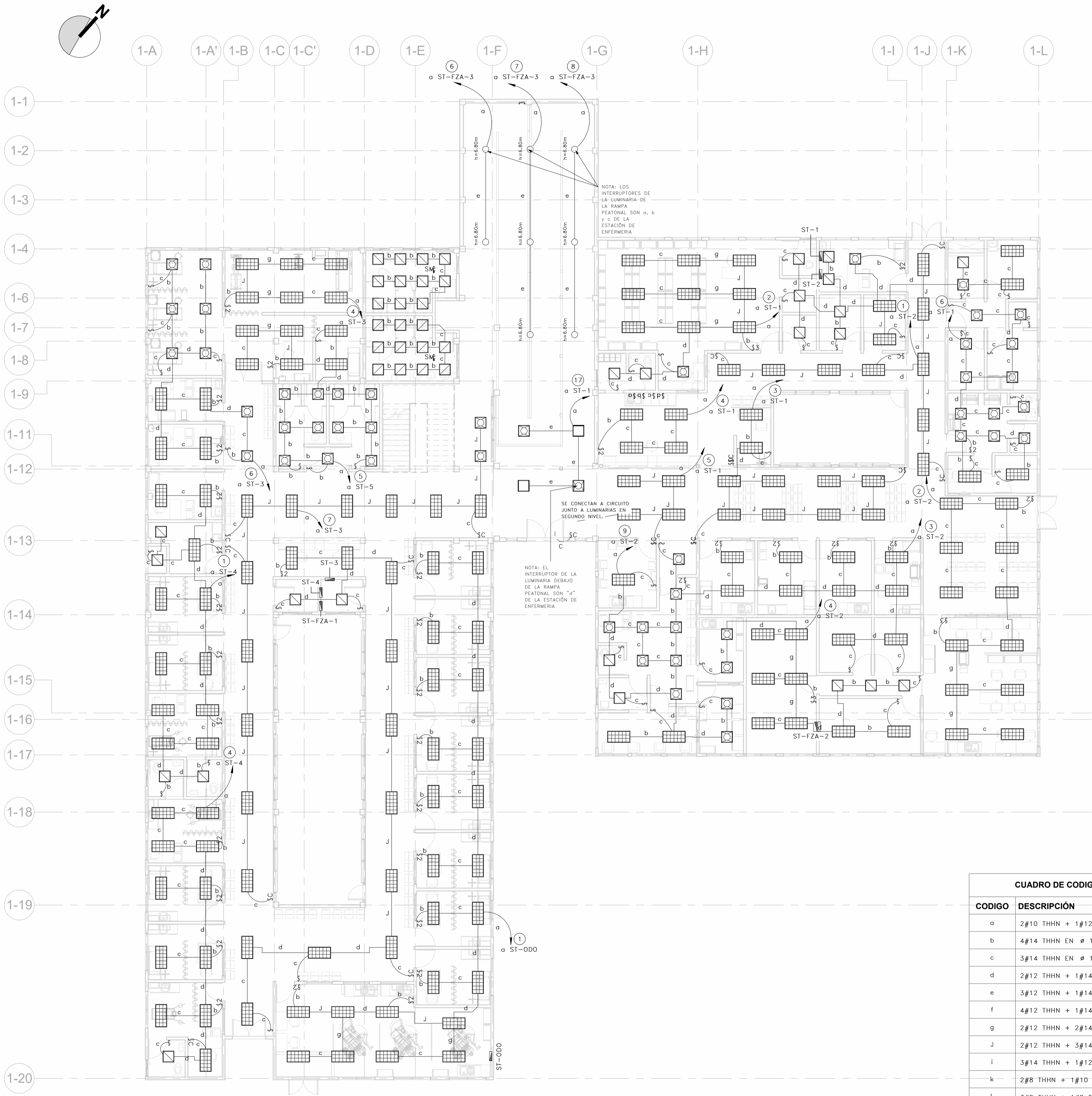
1 PLANO DE INSTALACIONES ELÉCTRICAS DE LUMINARIAS DE PRIMER NIVEL - MÓDULO 1 UNIDAD DE SALUD ESPECIALIZADA DE APOPA
