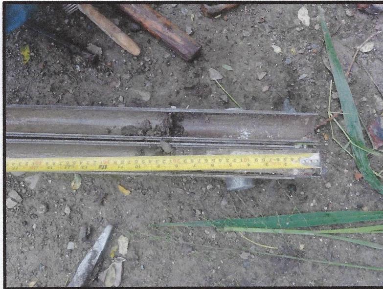
Cuchara partida con muestra obtenida en área de Sondeo 20.
