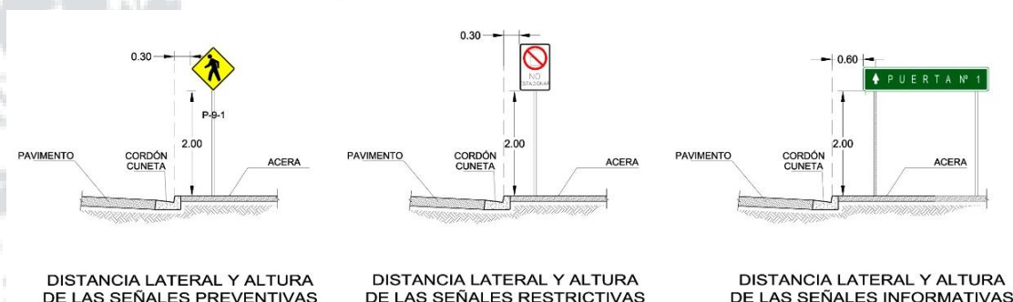
Figura 27. Altura y distancia lateral libre de las señales verticales en zonas rurales y áreas urbanas. Fuente: Manual Centroamericano de Dispositivos Uniformes para el Control de Tránsito, Anexo del Acuerdo Centroamericano sobre Señales Uniformes, Año 2000.
