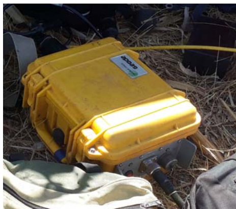
Figura 4 – Equipos empleados durante la fase de adquisición (Sismógrafo Geometrics 24 canales y geófono vertical).
