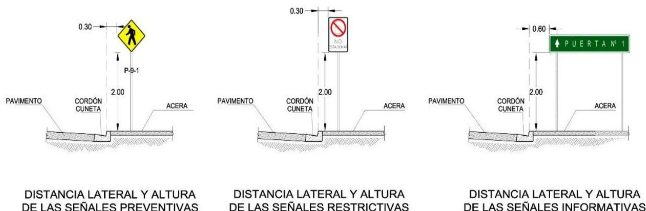
ILUSTRACIÓN 46 ALTURA Y DISTANCIA LATERAL LIBRE DE LAS SEÑALES VERTICALES EN ZONAS RURALES Y ÁREAS URBANAS
