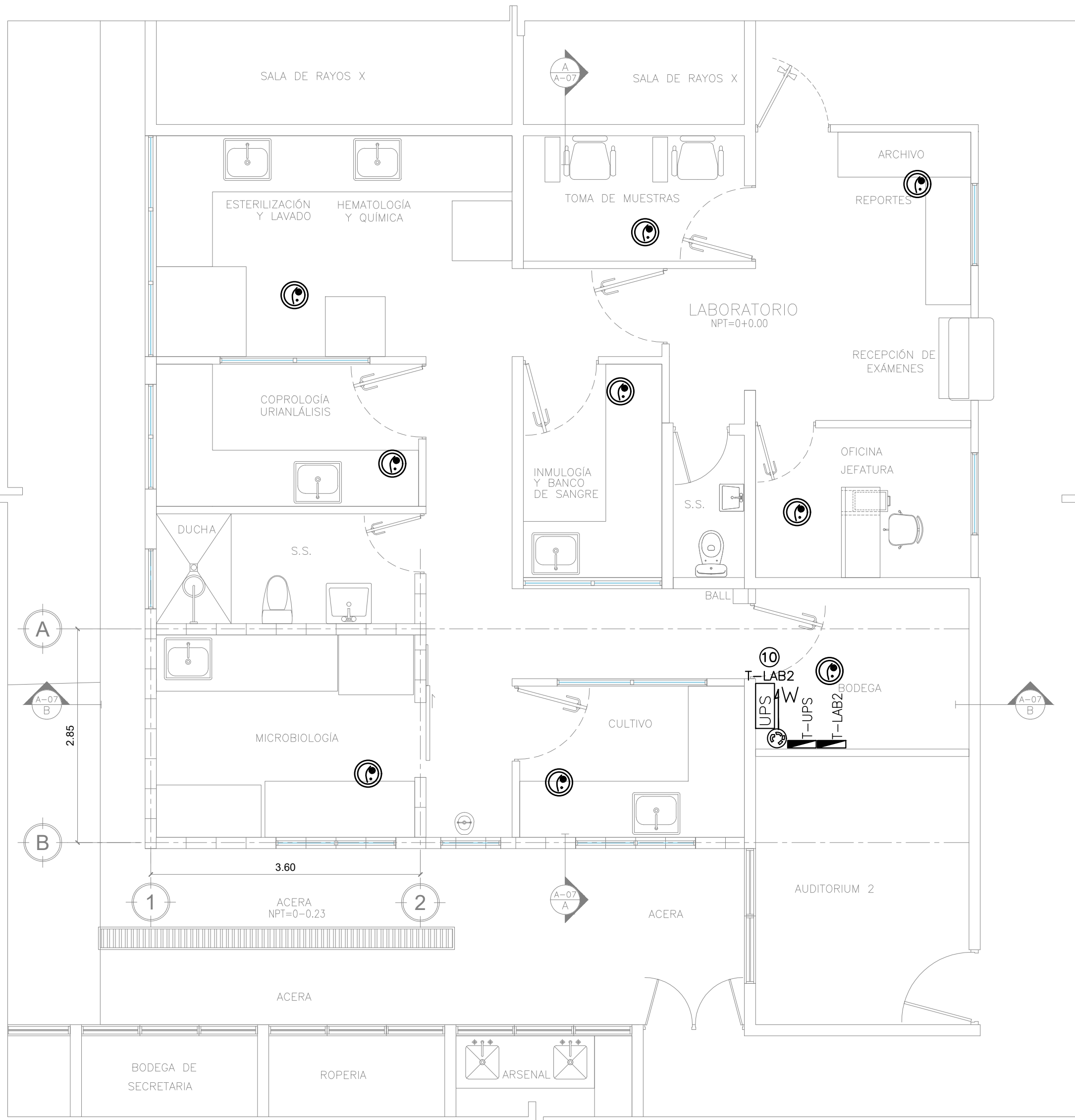
PLANTA DE DETECTORES DE HUMO SITUACIÓN PROYECTADA Esc 1:50
