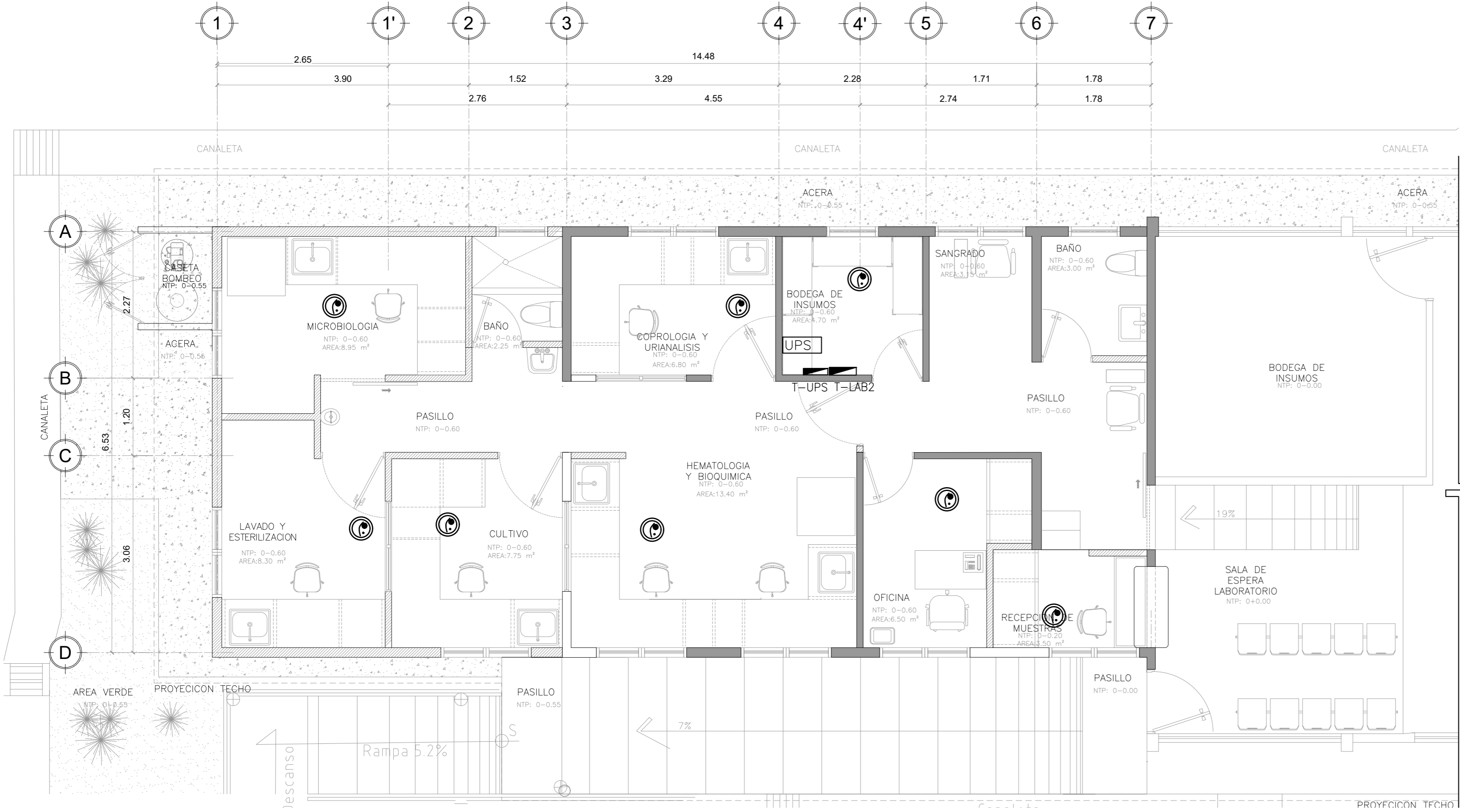
PLANO DE SENSORES DE HUMO PROYECTADOS UNIDAD DE SALUD APASTEPEQUE Esc 1:50
