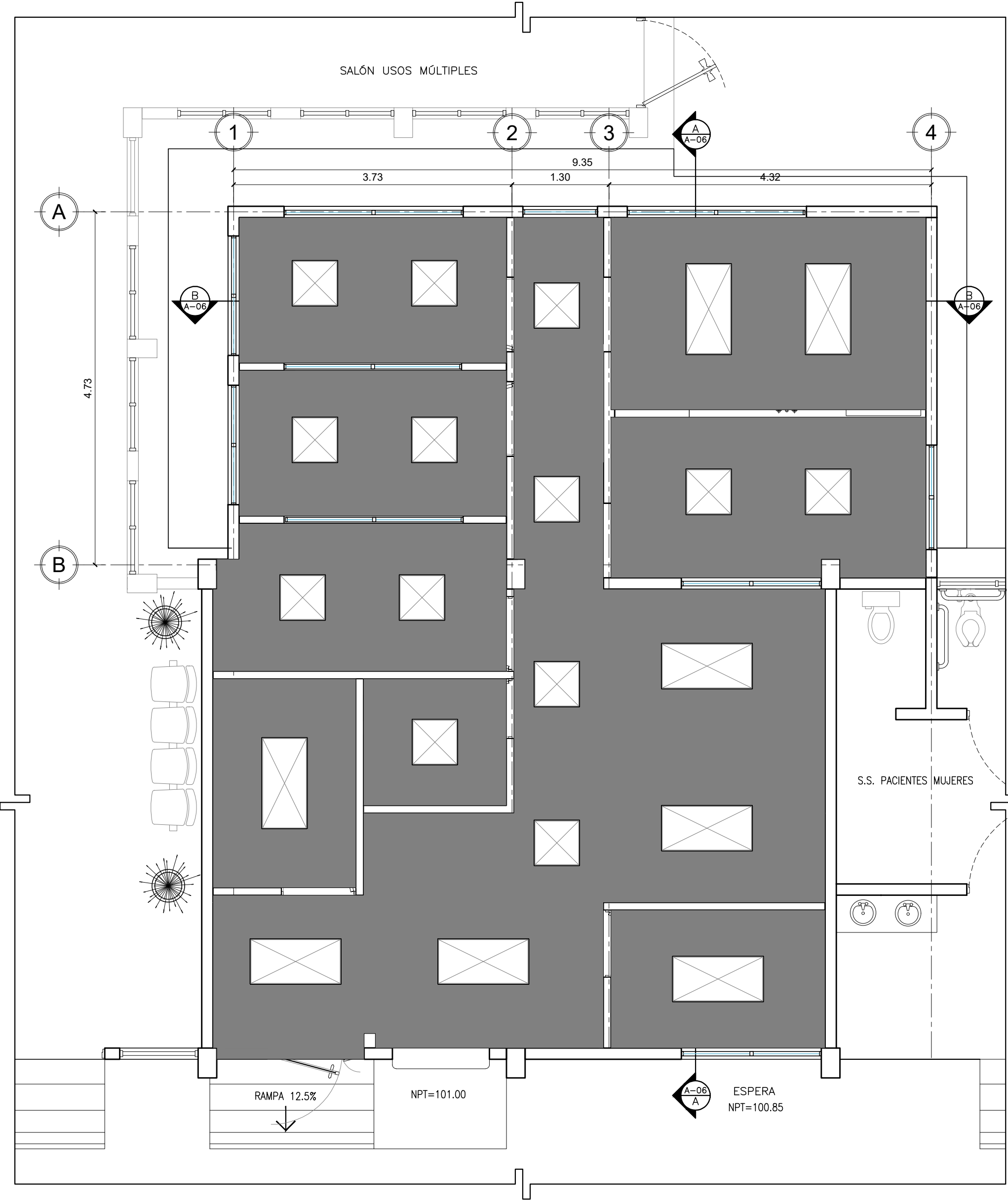
PLANTA ARQUITECTÓNICA DE CIELO REFLEJADO SITUACIÓN PROYECTADA Esc 1:50
