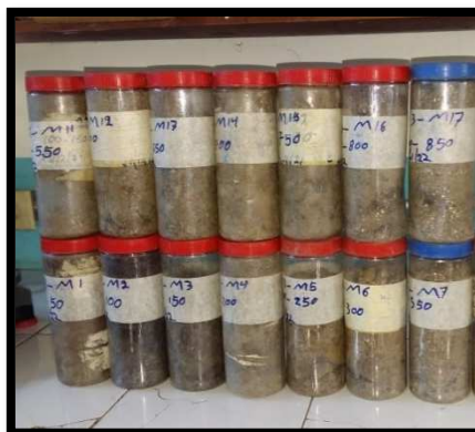
Ilustración 4. Recolección y Manejo de muestras de Ensayo SPT.
