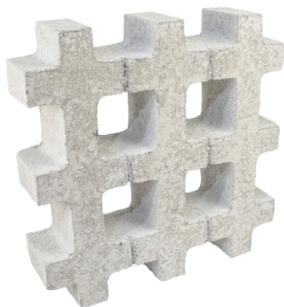
El piso a instalar deberá ser adoquín de concreto tipo ecológico color gris, estos elementos deberán cumplir con las dimensiones siguientes 44x44x10 cm peso 50 lb. El área donde se instalará este material se prepara con una base de 10cm de tierra negra, se deberá nivelar y acomodar en base a los niveles y pendiente proyectados en los planos constructivos.
