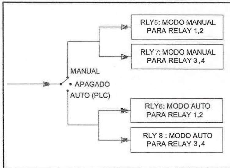
**DIAGRAMA FUNCIONAL: MODOS MANUAL-APAGADO-AUTO**
