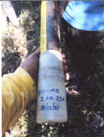
Muestra de suelo obtenida de sondeo de exploración S3, a una profundidad de 2.50m
