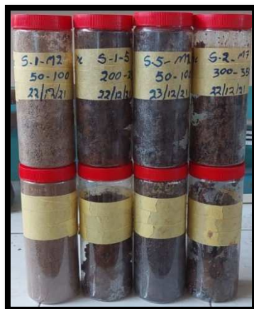
Ilustración 4. Recolección y Manejo de muestras de Ensayo SPT.
