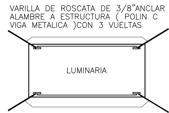
DETALLE DE APOYO DE LUMINARIAS SIN ESCALA
