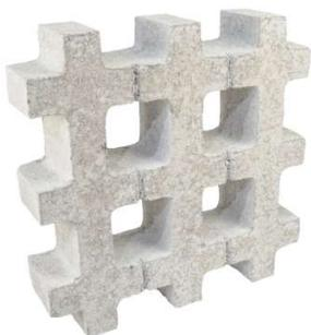
El piso a instalar deberá ser adoquín de concreto tipo ecológico color gris, estos elementos deberán cumplir con las dimensiones siguientes 44x44x10 cm peso 50 lb. El área donde se instalará este material se prepara con una base de 10cm de tierra negra, se deberá nivelar y acomodar en base a los niveles y pendiente proyectados en los planos constructivos.
