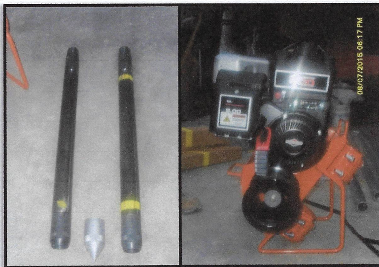
Cuchara partida y motor de perforación.
