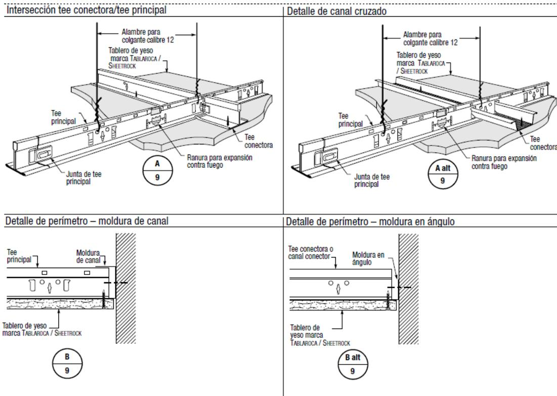
Figura. Suspensiones tipo para cielo de tablayeso
