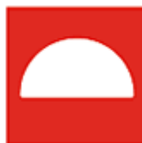
6 CONJUNTO DE EQUIPOS CONTRA FUEGO
