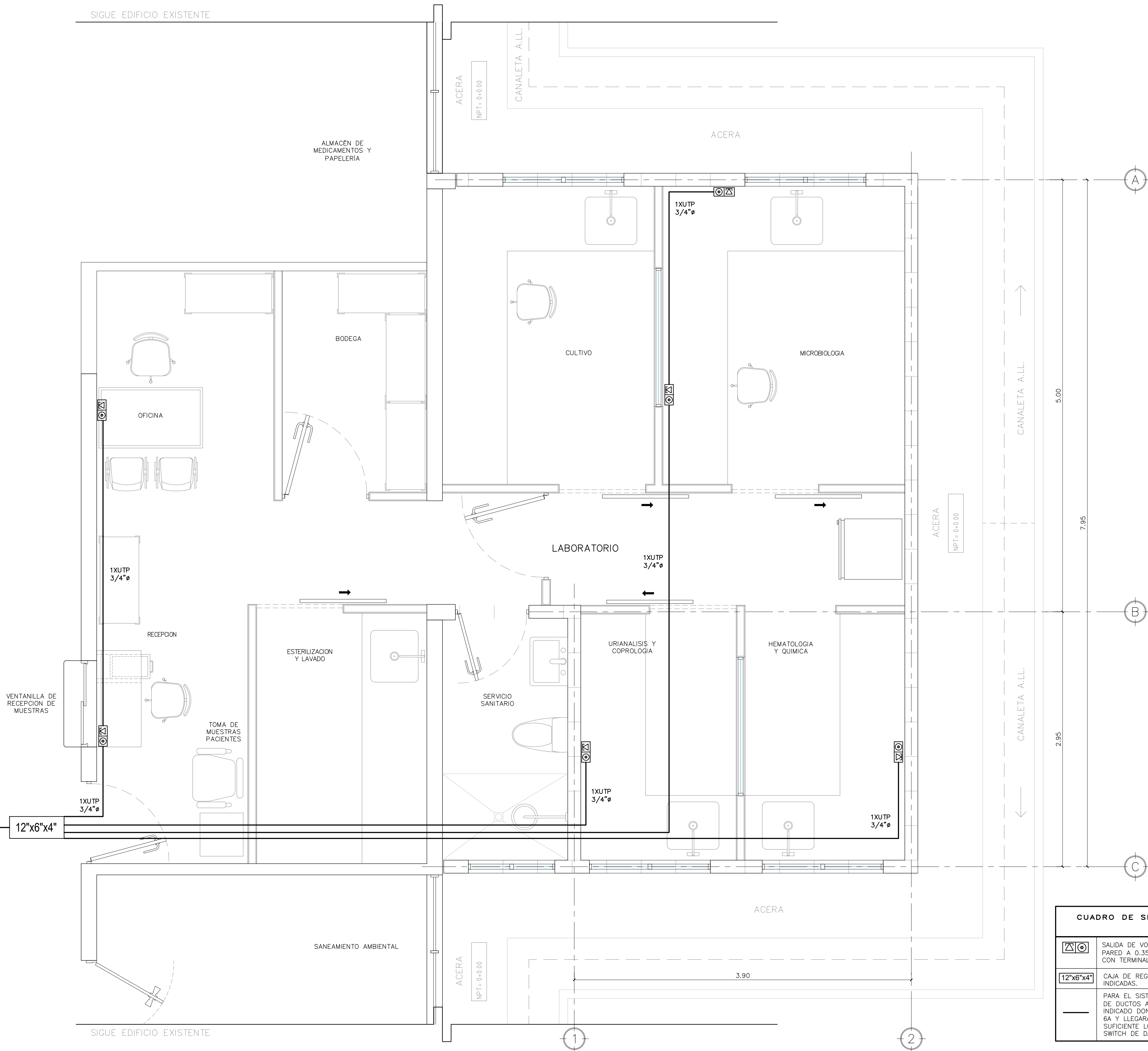
PLANTA DE INSTALACIONES DE VOZ Y DATOS UNIDAD DE SALUD JUCUAPA Esc 1:25
